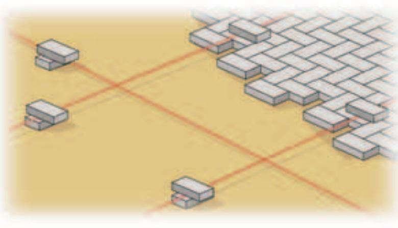
Terminata la posa in opera dei masselli la larghezza dei giunti deve essere uniforme e non superiore a 3 mm (Figura n. 2.18): si procede ad un primo intasamento con sabbia fine asciutta e quindi alla vibrocompattazione a mezzo di piastra munita di tappetino protettivo in gomma o similare, estendendo l'operazione anche alle zone indisturbate limitrofe all'area di intervento per un'ampiezza di circa 50÷70 cm (Figura n. 2.19).
