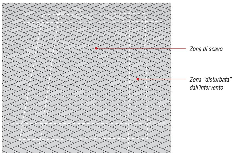
Si tenga presente che i masselli rimossi verranno riutilizzati, per cui è preferibile utilizzare per la marcatura materiali facilmente lavabili: l'utilizzo di vernici sarà comunque necessario nel caso in cui la pavimentazione sia sottoposta ad intenso traffico veicolare e trascorra diverso tempo tra il tracciamento dell'area di scavo e la recinzione della stessa.
