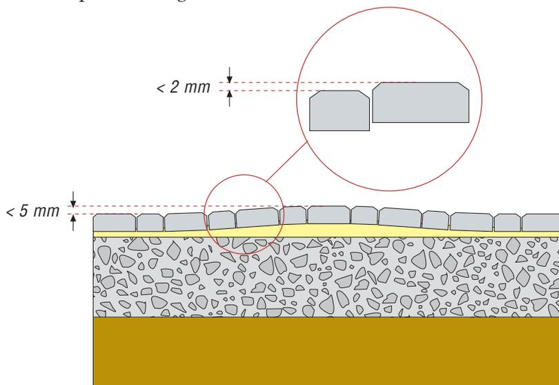
Sarà sufficiente un breve periodo di tempo e di esposizione ai carichi di esercizio perché qualunque traccia dell'intervento venga a sparire e sia ripristinata la planarità della pavimentazione.
