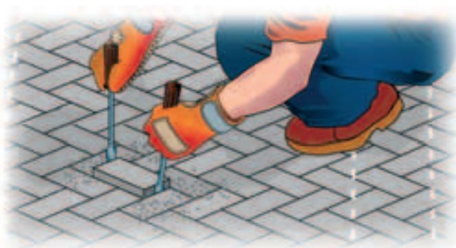
Quando il massello è stato sollevato ad un'altezza sufficiente, può essere estratto direttamente con le mani (o facendo leva con una cacciavite inserito al di sotto dello stesso (Figura n. 2.5).
